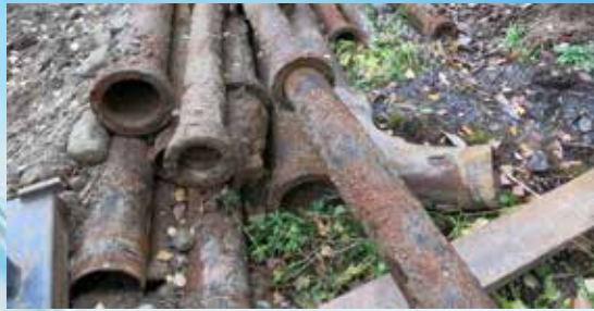
Gamla slitna rör byts ut. Rickard Persson, Jörgen Sköld och Sven-Erik Bäckman ser till att vi har vatten i kranen. Ibland är jobben akuta, men vattenledningarna byts också enligt plan för löpande underhåll.
